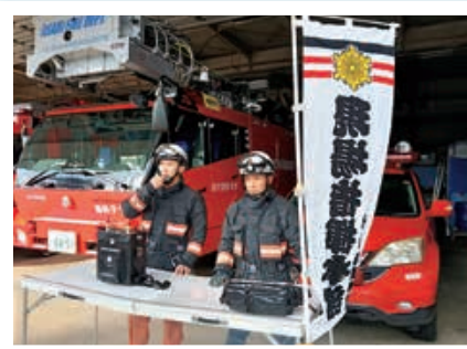
災害現場で現場指揮本部が使用する可搬型の無線装置です。
