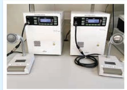
旭市消防本部に設置され、ちば消防共同指令センターとの無線交信に使用します。
