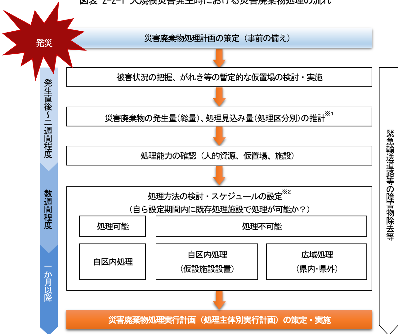
図表 2-2-1 大規模災害発生時における災害廃棄物処理の流れ
