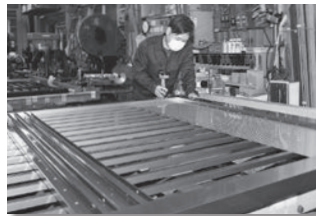
扉を組み立てる作業
