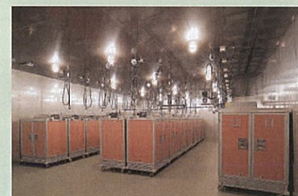
■ 急速冷蔵した料理を冷温保管するカートプール
