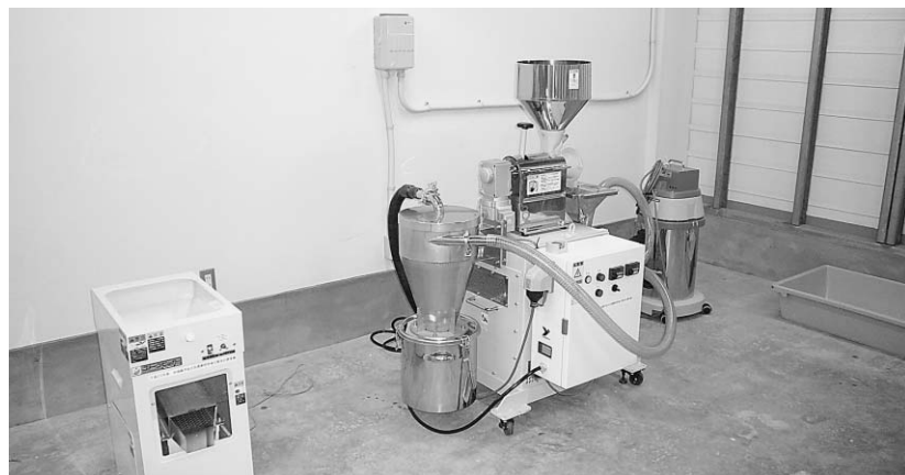
農産物処理加工センター(萬歳地区)に設置された米粉製粉機
